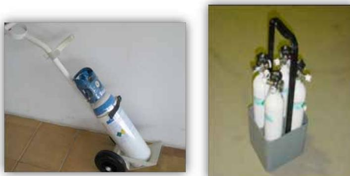
**Figura 8:** Equipamentos de transporte utilizados na distribuição de cilindros.
