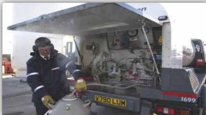
**Figura 5:** Processo de abastecimento de gases medicinais pela empresa fornecedora, por transferência de cisternas para reservatórios criogênicos fixos (tanques) e móveis na central de gases.
