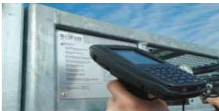
**Figura 4:** Processo de rastreabilidade, obrigatório no circuito dos gases medicinais (com recurso a códigos de barras).
