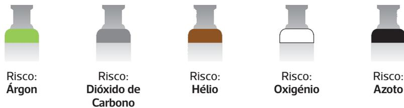
A cor de base da ogiva do cilindro é pintada de acordo com a cor do gás contido no cilindro em maior quantidade. A natureza dos outros gases é representada por riscas ou barras coloridas, conforme se exemplifica na figura seguinte:
